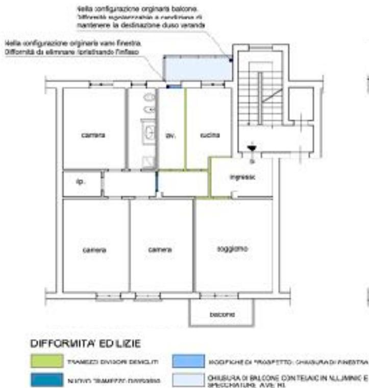
Fig.36 Sintesi delle difformità edilizie
