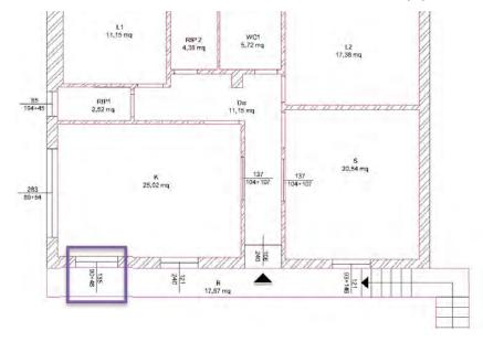
modifica delle dimensioni della finestra del vano adibito a cucina (K), ubicata sul prospetto Sud del fabbricato, le cui dimensioni risultano essere pari a 283x64 centimetri:
