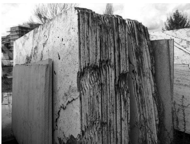
Foto n.6 – lastre “Pietra portoghese” e “Travertino”
