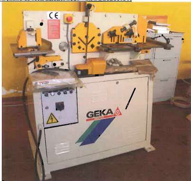
CESOIA-PUNZONATRICE/TAGLIAFERRI IDR. GEKA mod. MINICROP45 Macchina nuova (anno di costruzione: 2002 - S.N. 8611)
