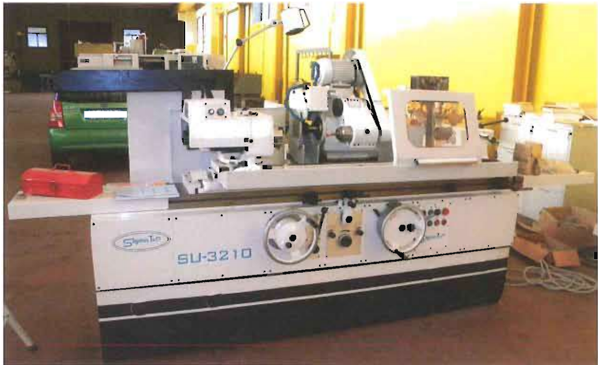
RETTIFICATRICE CILINDRICA SIGMATOP mod. SU3210 (con visnalizzatore Mitutoyo KA12). Macchina nuova (anno di costruzione: 2010 - S.N. SU3210030)
