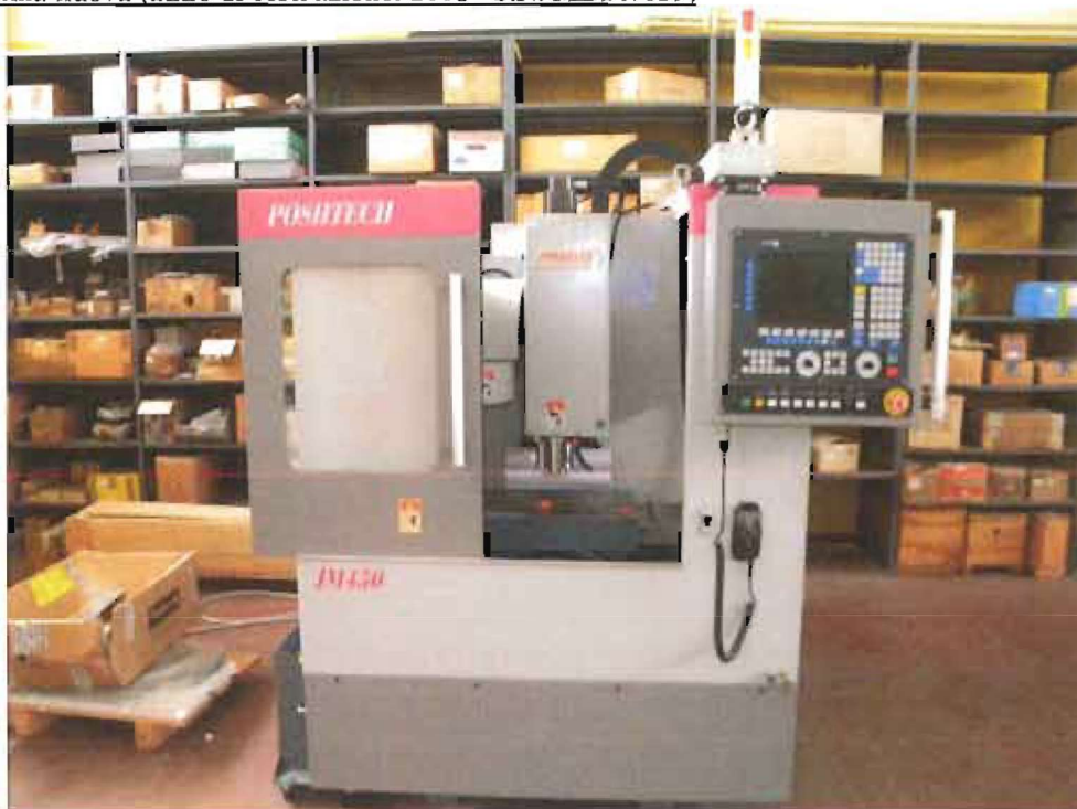
CENTRO DI LAVORO VERTICALE POSITECH mod. JM450 (con controllo Fagor). Macchina nuova (anno di costruzione: 2008 - S.N. M081004096)
