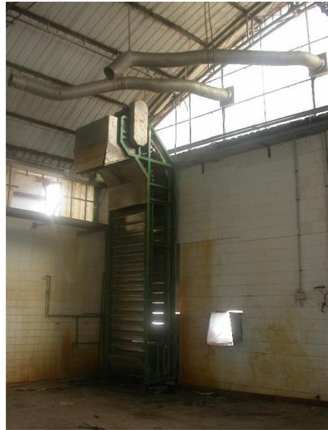
**Figg.22-23 impianto di torchiatura + scala e pedana e nastro trasportatore a tazze**
